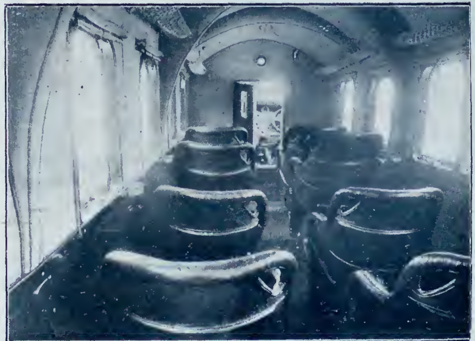
Interno della cabina dello Junkers G. 23
